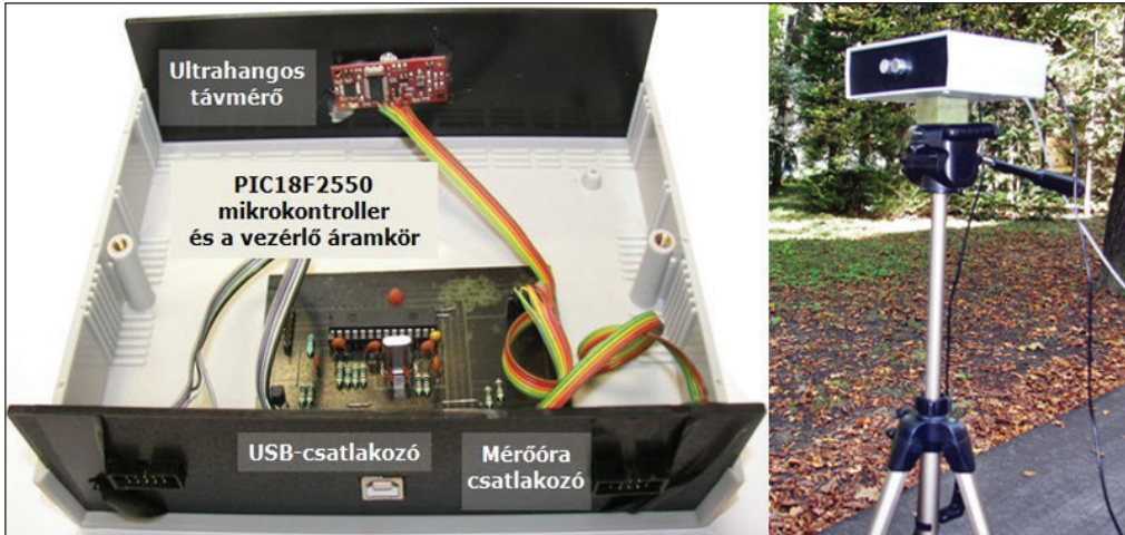
4. ábra: A központi adatgyűjtő-vezérlő egység Figure 4: Central data logging unit
