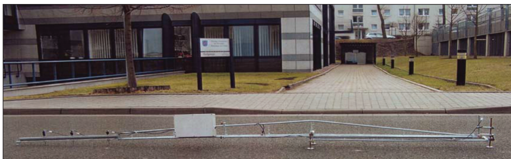
2. ábra: Automatizált Benkelman-tartó. (Dähnert 2005) Figure 2: Automated Benkelman-beam. (Dähnert 2005)
